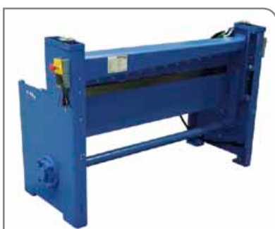
Cisaille haute capacité pour >1.5 mm
